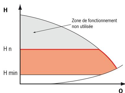
L'électronique maintient constante, via le régime de débit autorisé, la pression différentielle produite par la pompe à la valeur de pression différentielle de consigne H<sub>n</sub>, jusqu'à la courbe de fonctionnement caractéristique maximale.
