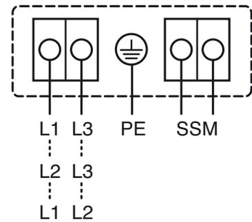
Ou entre 2 phases d'un réseau 3~230V
