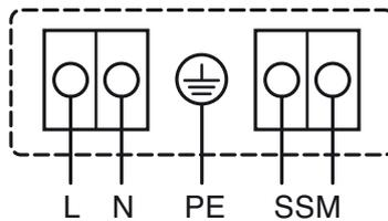
Raccordement à un réseau 1~230V
