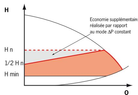
L'électronique modifie de façon linéaire entre H<sub>n</sub> et 1/2 H<sub>n</sub> la valeur de pression différentielle de consigne à respecter par la pompe. La valeur de pression différentielle de consigne H augmente ou diminue avec le débit demandé.
