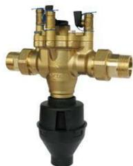
Pression PFA 10 bar 65°. Disconnecteur à zone de pression réduite contrôlable avec entonnoir incorporé - encombrement réduit - membrane à moulure et talon - fiabilité prolongée et maintenance facilitée. Corps. Chapeau. Douille. Ecrous : Laiton. Clapets : PPO (polyphénylène oxyde) ou PPA (polyphthalamide). Joints : EPDM. Ressort : inox.
