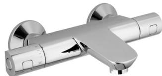
C3 avec coupure en cas de température >50°C. Corps «froid». Poignée ABS. Sélecteur céramique douche/bain sur poignée. Entraxe 150 mm. Saillie 180 mm. NF C3 Classe E 3/1 C3 A1 U3 (code usine SPL72255).
